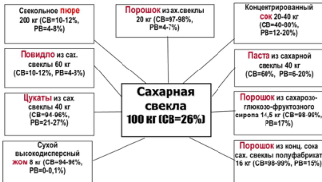
Рисунок 2. Схема получения продуктов переработки сахарной свёклы. СВ – сухое вещество, РВ – редуцирующие вещества
